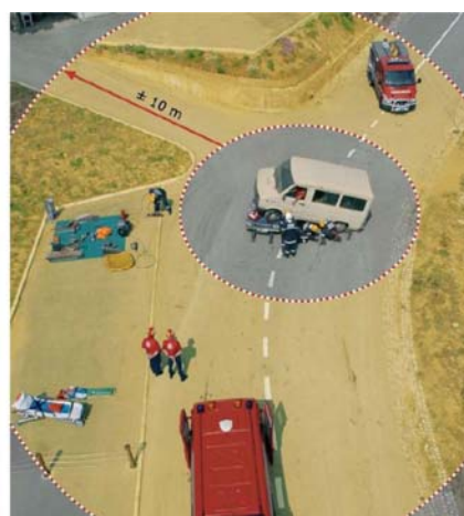
Figura 2 - Exemplo de estacionamento e isolamento
